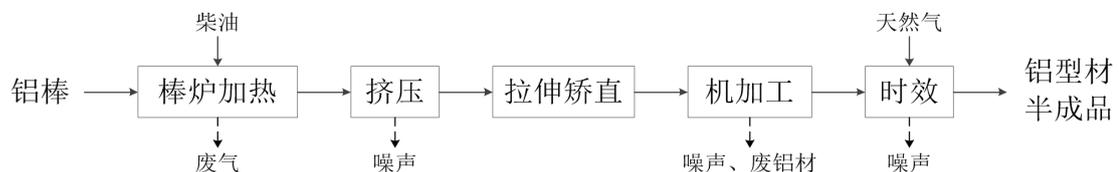
图 2-15 原有项目挤压成型工艺流程图
