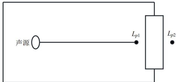
图 4-2 室内声源等效为室外声源图例
